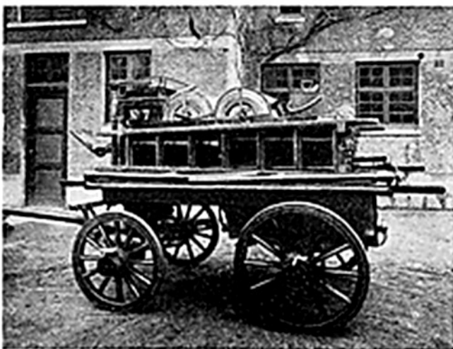
Fig. 66. Handkraftspruta från år 1862.
