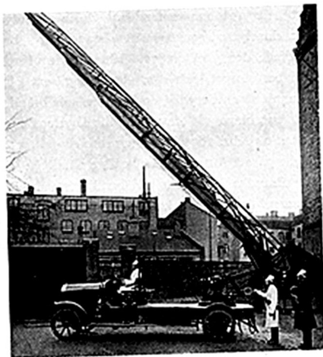
Fig. 74. Brandkårens 28-meters motorstege. Inköpt 1921.
