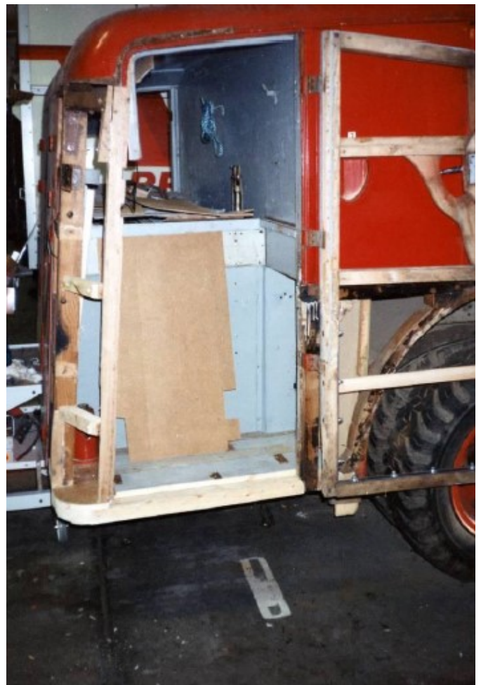
En del av trästommen byttes ut
